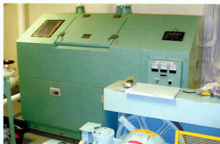
B) 独立行政法人 航海訓練所 練習船内 水中無加熱分解消滅タイプ (4年間メンテナンス・フリー)
